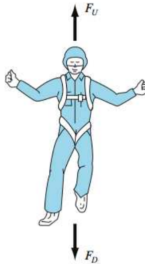
Figura 1.1: Representación de las fuerzas que actúan sobre un paracaidista en descenso. F_D es la fuerza hacia abajo debido a la atracción de la gravedad. F_U es la fuerza hacia arriba debido a la resistencia del aire.
